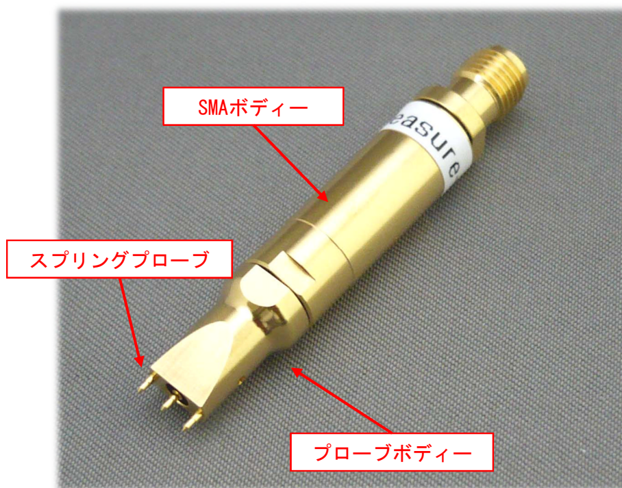
写真1-1 同軸プローブの各部名称
