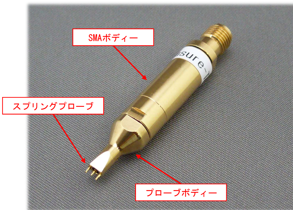
写真1-1 同軸プローブの各部名称
