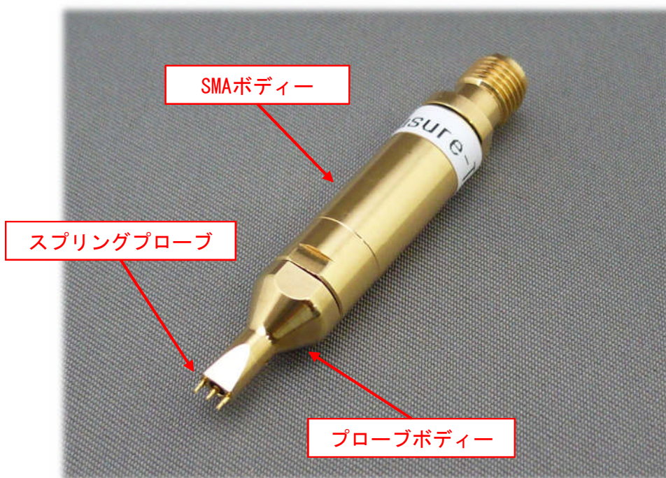
写真1-1 同軸プローブの各部名称
