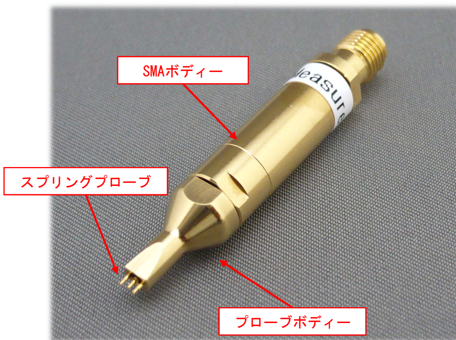
写真1-1 同軸プローブの各部名称
