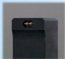
給電点接触部
