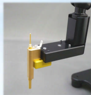
同軸ケルビンプローブ装着
