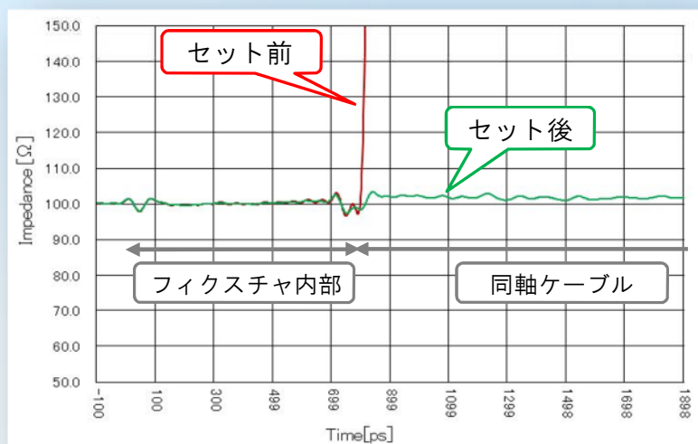
同軸ケーブルセット前後のインピーダンス特性
